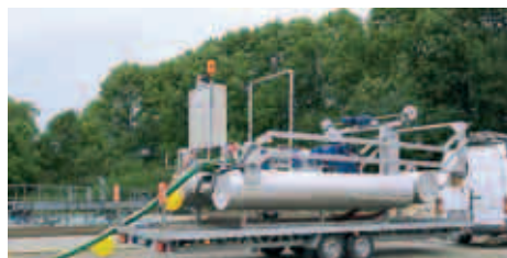
Transport flexible et simple du racleur de boues de fond.
